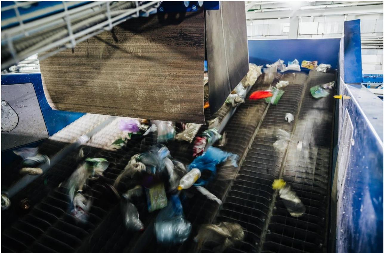
Рис. 22. Процесс баллистической сепарации
