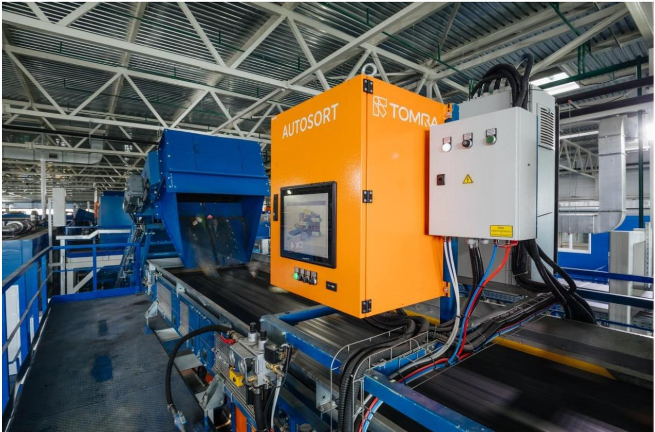
Рис. 21. Оптический сепаратор
